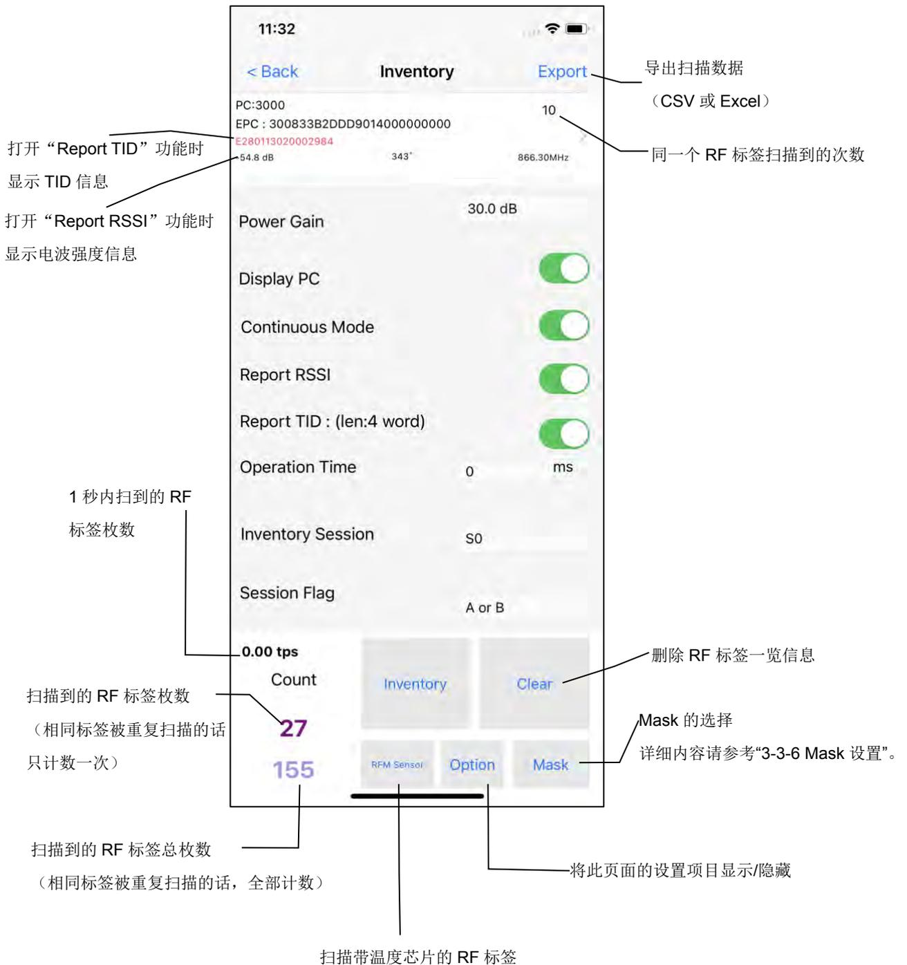
④点击标签一览表中显示的 RF 标签，就可以进行扫描 / 写入 / Lock 操作。详细内容请参考“3-3 RF 标签的各种设置”。
